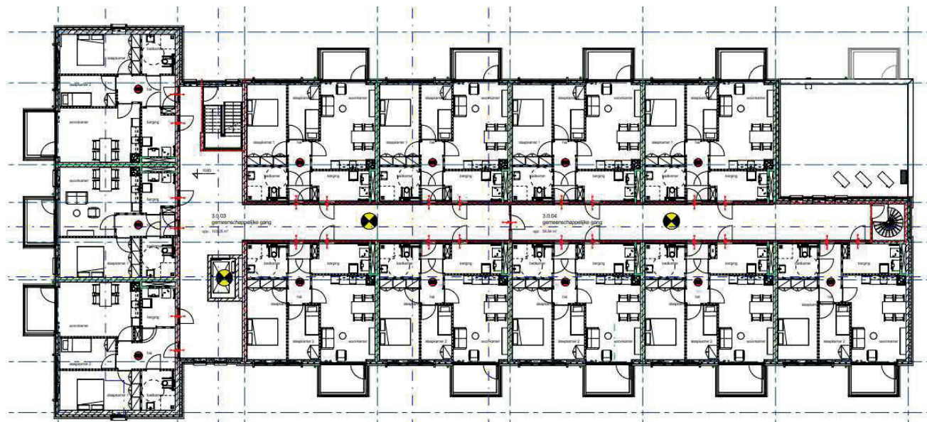
Figuur 8-1 Opstelling buitenunits warmtepompen 3e verdieping (9.180+P)
